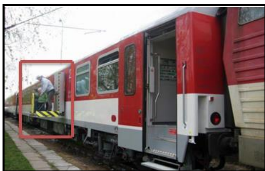
Obrázok 5 Vozeň radu Bdsheer so zdvíhacou hydraulickou plošinou
