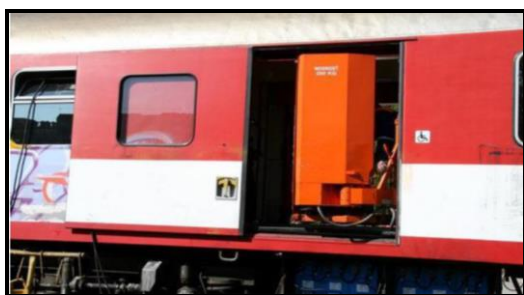
Obrázok 5 Vozeň radu Bdsheer so zdvíhacou hydraulickou plošinou
