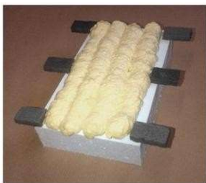
Obrázok F.4.3 – Nastavenie pomocou dištančných prvkov (ex. 2)
