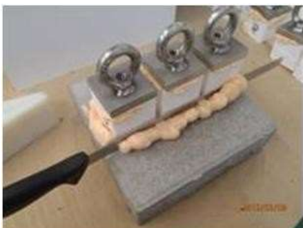
Obrázok F.4.7 – Rezanie prebytočnej peny
