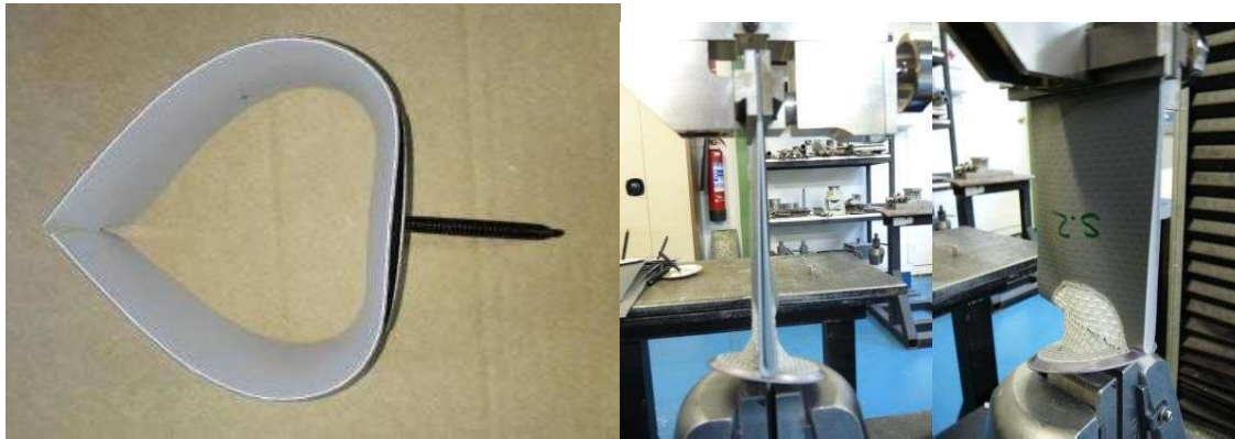
Obrázok 1 – Odlupovanie pásu kotviacim prvkom
