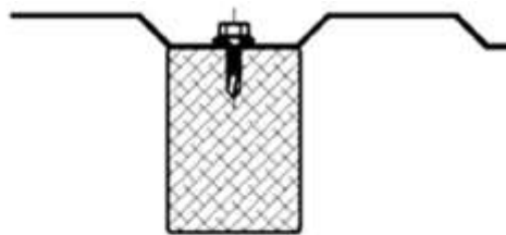
upevnenie prášného profilu na drevenom podklade
